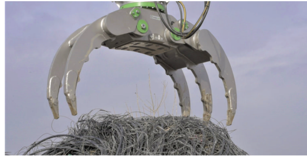
Alligator-Greifer - das beste Werkzeug für scharfen Stahlbau
